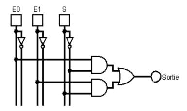
La construction du Multiplexeur 2 entrées en utilisant les Tristates Buffers :
